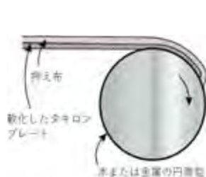
図 18. 外周巻付け円筒加工法
