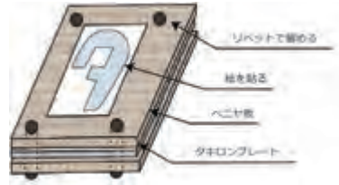
図 4. 糸鋸切断法一例
